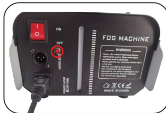
3. Attendre que l'indicateur s'allume et fonctionne à distance
